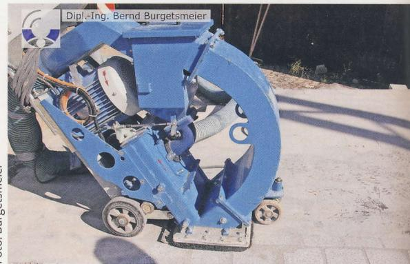
Abbildung 4: Strahlvorgang. Die ausgehärtete Fläche muss trocken sein, Ausführungstemperaturen: -20°C bis +40°C.
